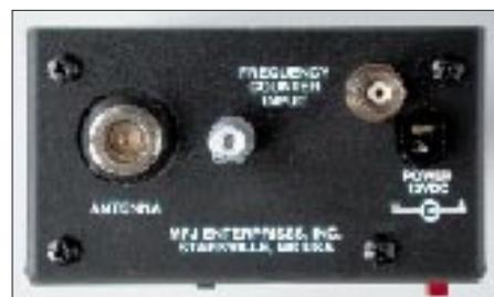
Die Draufsicht zeigt Antennen-, Zähler- und Stromversorgungsbuchse sowie die Erdungsklemme.
